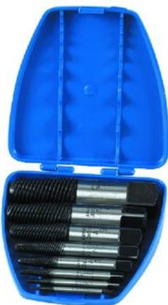
Univerzalna upotreba za različite prečnike vijaka. U odlomljeni vijak izbušiti rupu (po tablici). U tu rupu okretanjem u levo zavija se odvijač zalomljenih vijaka sve dok spoj ne popusti i ne odvije zalomljeni vijak. Birati što veći prečnik odvijača. Kompletno u plastičnoj kutiji.
