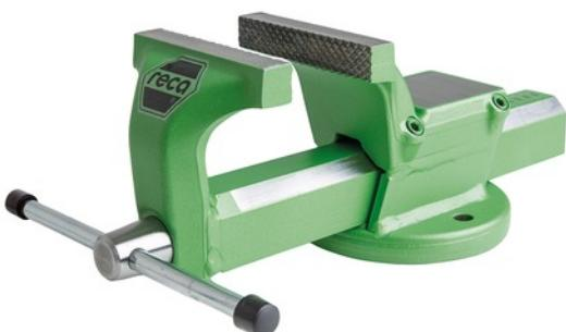
Stega kovana od čelika, otporna na udarce, stezne čeljusti glodane i površinski kaljene, vreteno sa valjanim trapeznim navojem, vodiča podesiva, sa trajnim podmazivanjem, obezbeđuje dug životni vek uz robusnu upotrebu u radionici.
