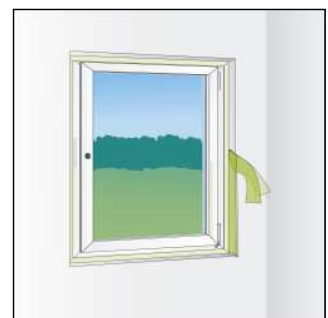
Bild 4: Nach Befestigung der Kammerleiste am Rahmen Aktivierung von TP001 illmod i durch Abtrennung der überstehenden Folie.
