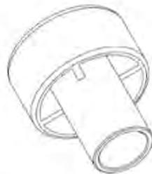
**Injektionsadapter für Überkopf- oder Horizontalmontage**
