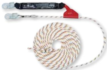
Mitlaufendes Auffanggerät an beweglicher Führung oder auch Seilkürzer genannt. Das Gerät blockiert in einer Richtung und kann so eingestellt werden, dass der Anwender sich gerade bis zur Absturzkante frei bewegen kann und so nicht über die Kante stürzt.
