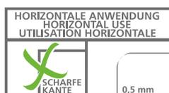
Geeignet zur Anwendung bei vertikaler und horizontaler Benutzung bei einer Kantenbeanspruchung mit Radius  $r = 0,5$  mm. Eine Beanspruchung durch scharfe Kanten ist unbedingt zu vermeiden.
