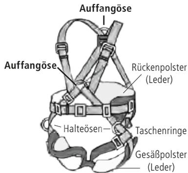
Der Auffanggurt verfügt über eine oder zwei Auffangösen. Nur die Auffangösen sind geeignet, die im Falle eines Absturzes auftretenden Kräfte so weiterzuleiten, dass ein Verletzungsrisiko weitgehend ausgeschlossen ist. Soll der Auffanggurt gleichzeitig als Haltegurt verwendet werden, muss er über Halteösen verfügen.
